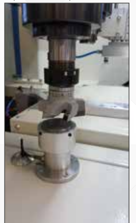
Azzeratore utensili automatico (di serie) Automatic tools zero setting (standard)
